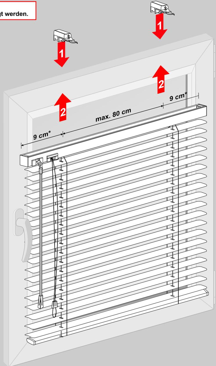
\* Der Abstand der Anbringung des Halters von der Aussenkante ist nicht immer gleich. Man soll die Träger nicht über bewegliche Getriebeteile montieren.
